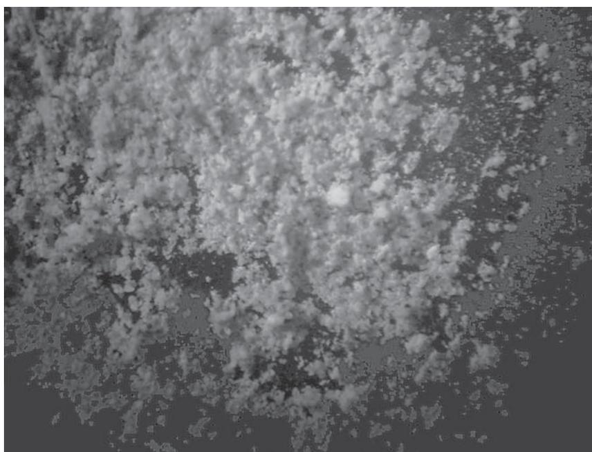
Рис. 3. Зола после сжигания водоугольного топлива
