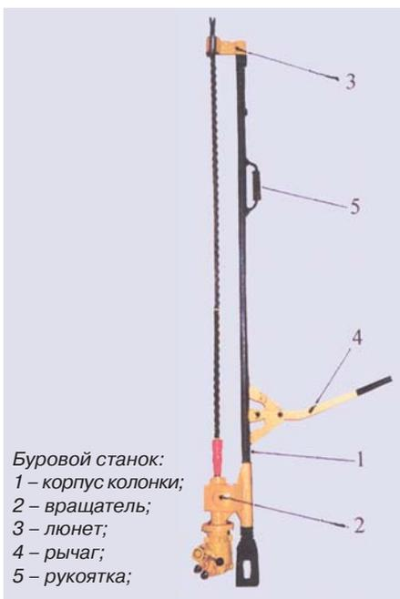
чае необходимости возможна замена гидродвигателя на ручные горные электросверла ЭР18Д-2М или пневмосверла СГП-1, что соответственно изменит основные показатели в технической характеристике станка.
