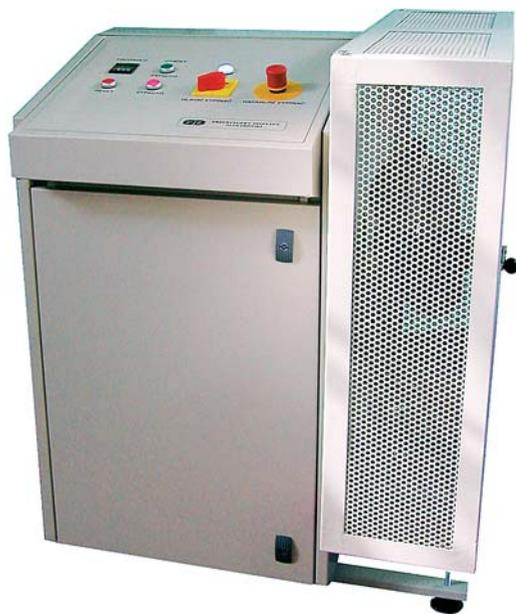
Рис. 3. Барaban для определения CSR
