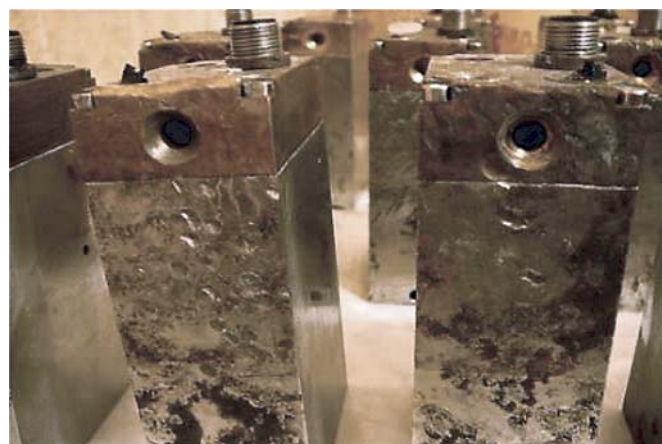
Фото 2. Клапаны со следами ударов по корпусу
