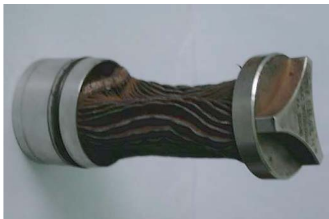
Фото 1. Многие фильтры повреждены подобным образом.
