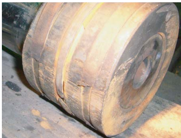
Фото 4. Полностью разрушенный цилиндр фирмы Tiefenbach
