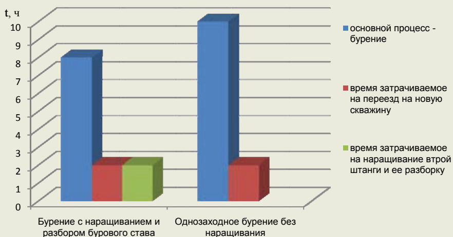
Рис. 3. Однозаходное бурение скважин без наращивания штанг
