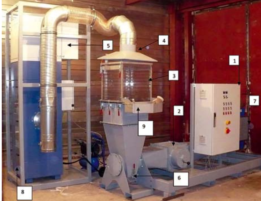
Рис. 4. Расплаивающая отсадочная машина allair® для циклических тестов: 1 — панель управления тестовой установкой; 2 — вращающийся клапан; 3 — отсадочная камера; 4 — рукав вытяжного фильтра; 5 — вытяжной фильтр; 6 — место сбора просыпей под сито отсадочной установки; 7 — главный нагнетающий вентилятор; 8 — место сбора пыли из отсадочной камеры; 9 — разгрузочный короб
