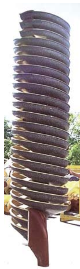
Рис. 1. Трехзаходный семивитковый спиральный сепаратор типа LD7RC
