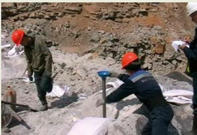
Рис. 1. Установка затвора на стойке для формирования воздушной (водяной) подушки
