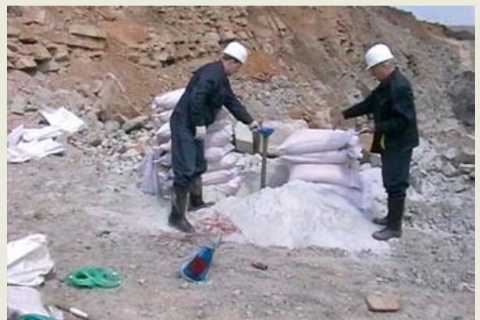
Рис. 1. Установка затвора на стойке для формирования воздушной (водяной) подушки
