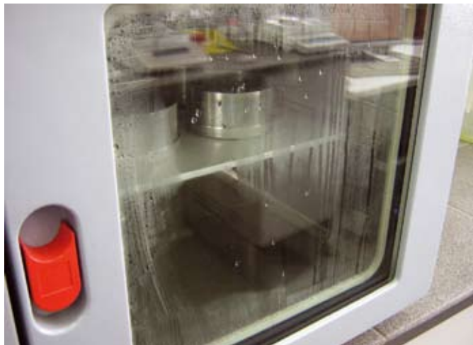
Рис. 3. Внешний вид сушильной камеры в процессе сушки в токе азота
