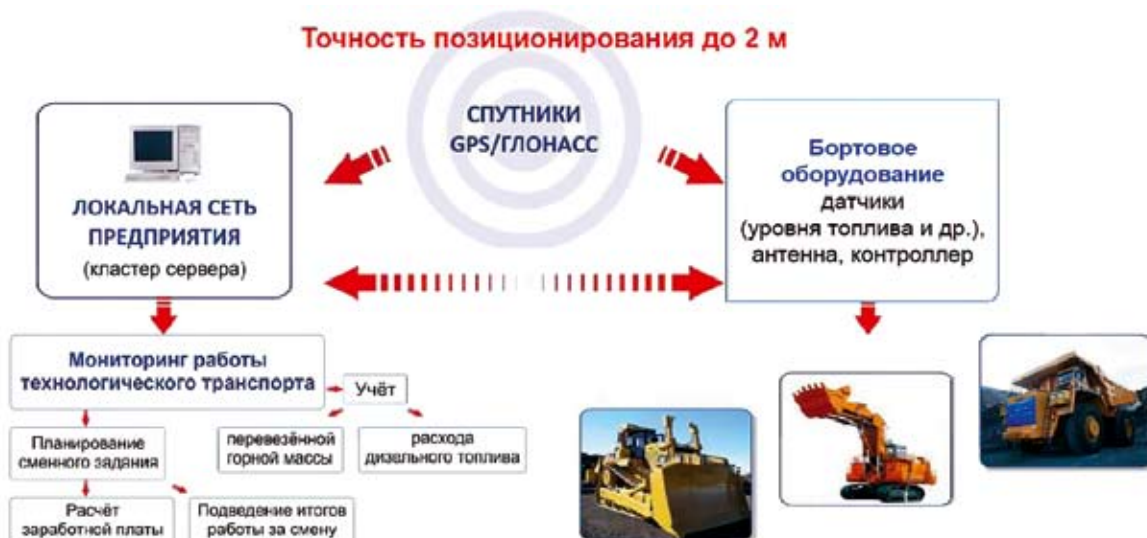
Схема работы системы диспетчеризации АСД «Карьер» (2D двухмерное позиционирование)
