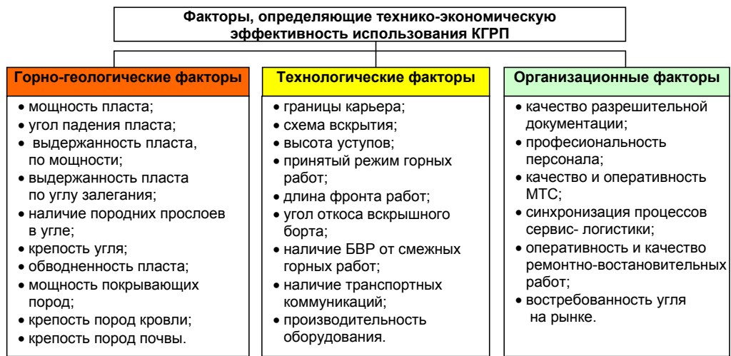
Рис. 4. Факторы, определяющие эффективность использования КГРП
