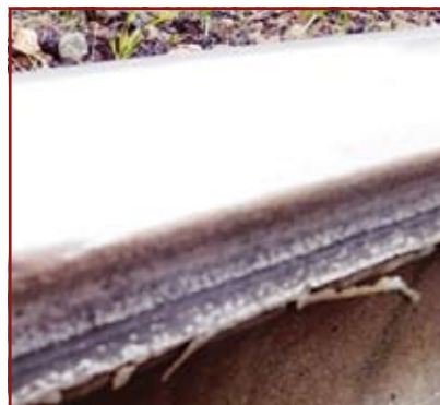
Рис. 4. Износ рабочей поверхности рельса, характерный для криволинейных участков карьерного рельсового пути
