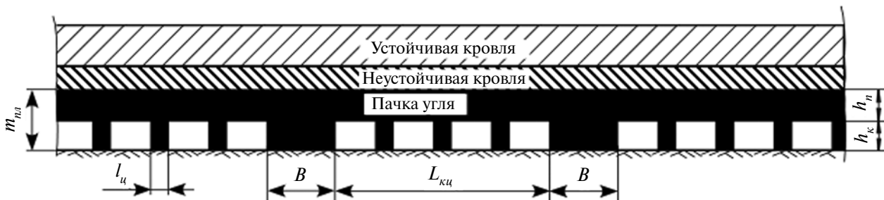
Рис. 6. Схема отработки пласта с неустойчивой (ложной) кровлей
