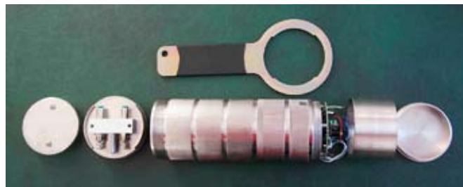
Рис. 1. Термобарометрическая колба для измерения газокинетических характеристик газоносного угля
