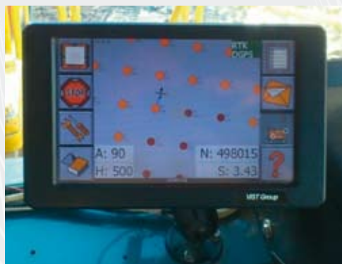
Рис. 3. Интеллектуальная панель в кабине бурового станка
