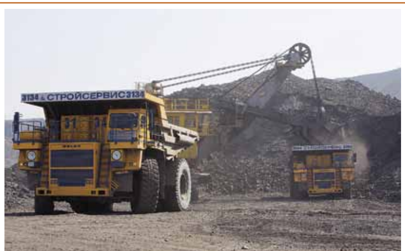
Рис.2. Экскаватор ЭКГ-18 № 13 с ковшем вместимостью 20 м 3 (SAE 2:1) в забое с погрузкой в автосамосвалы грузоподъемностью 130 т на разрезе ООО СП «Барзасское товарищество» ЗАО «Стройсервис»
