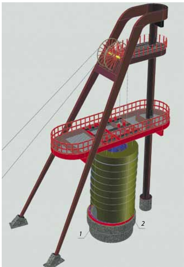
Рис. 2. Конструктивное решение копра многофункционального назначения: 1 – опорное кольцо станка; 2 – цилиндрический станок круглого сечения
