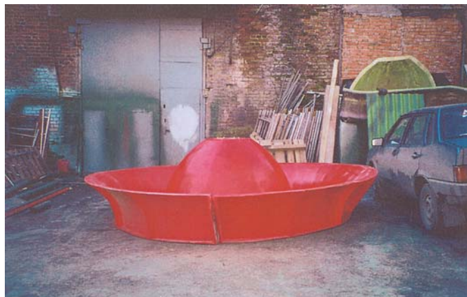
Обтекатель и коллектор (из композиционных материалов) вентилятора ВОД-30 ( D_{max} - 4,5 )
