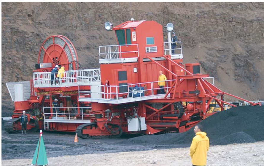
Комплекс КГРП, используемый на разрезе «Распадский» для подземной безлюдной выемки угля на выходах пластов на поверхность
