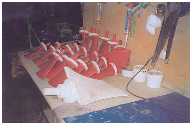
Готовые лопатки рабочего колеса осевого вентилятора (ВОД-16, ВОД-18) из композиционных материалов
