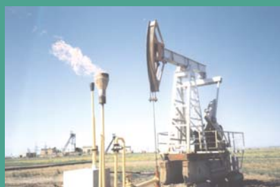
Освоение скважин гидрорасчленения станком-качалкой
