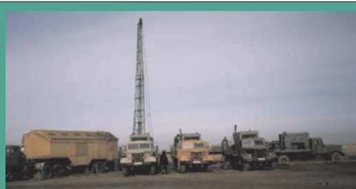
Гидродинамическая обработка угленосной толщи насосными агрегатами
