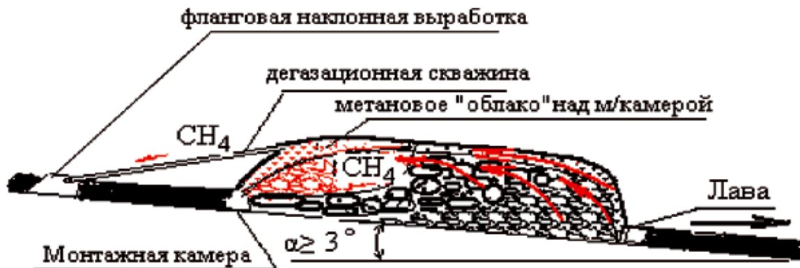
Рис. 3. Способ дегазации выработанного пространства и предотвращения распространения взрыва метана из выработанного пространства в очистной забой и прилегающие к нему выработки
