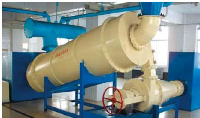
Рис. 3. Серийный гидроциклон трехпродуктовый тяжелосредный 3GHMC
