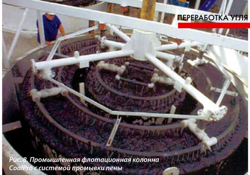
Рис. 8. Промышленная флотационная колонна CoalPro с системой промывки пены
