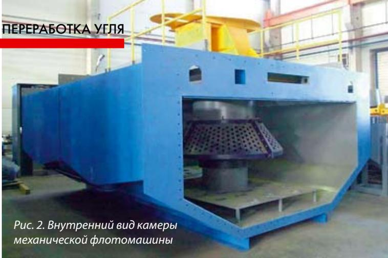
Рис. 2. Внутренний вид камеры механической флотомашин
