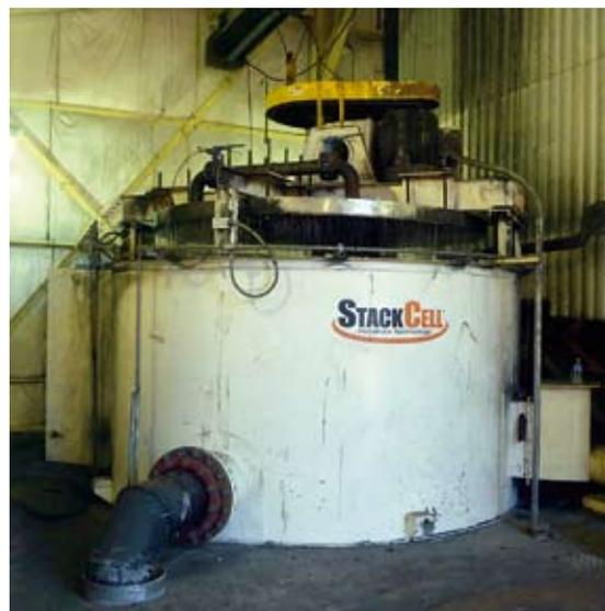
Рис. 13. Фото флотомашин StackCell на действующей обогатительной фабрике в США
