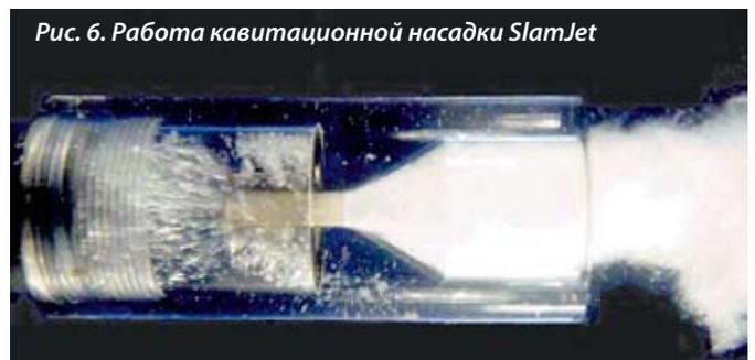
Рис. 6. Работа кавитационной насадки SlamJet
