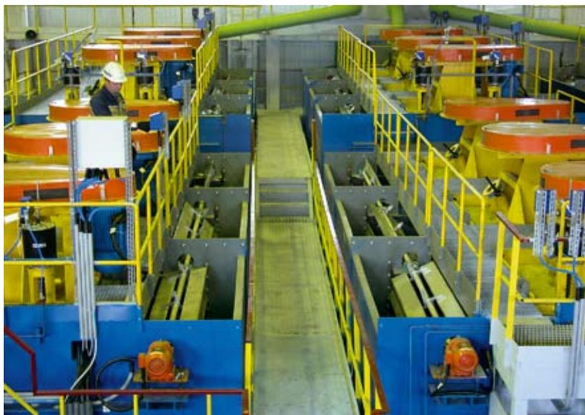
Рис. 1. Камерные механические флотомашин SETCO на новой фабрике в Кузбассе
