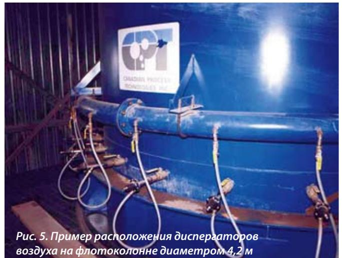
Рис. 5. Пример расположения диспергаторов воздуха на флотоколонне диаметром 4,2 м
