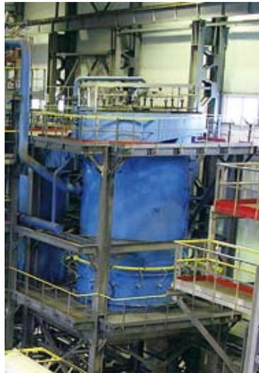
Рис. 4. Вид колонной флотомашин
