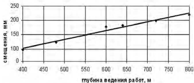
Рис. 2. Зависимость смещений пород приконтурного массива от глубины ведения работ (а) и их прочности на одноосное сжатие со стороны кровли (б)
