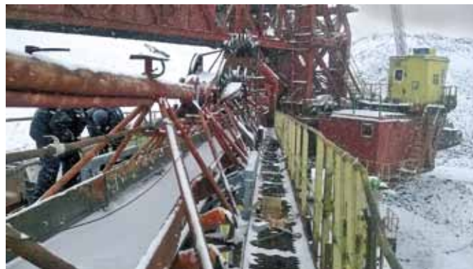
Монтаж весовой системы на стреле роторного экскаватора, Переясловский разрез АО «Красноярсккрайуголь»
