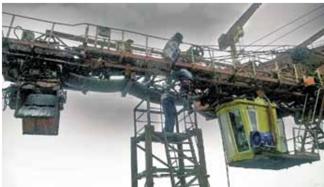
Монтаж весовой системы на стреле роторного экскаватора, Переясловский разрез АО «Красноярсккрайуголь»
