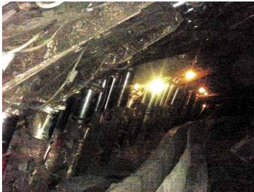
Рис. 5. Действующая эксплуатация SMK: SMK наклонены на забой, поддерживающие и оградительные элементы находятся на одной линии или в одной плоскости, поддерживающая способность утрачена (отсутствует)
