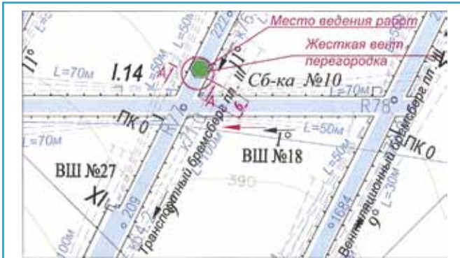
Рис. 1. Выкопировка из плана горных работ пласта III участка КСО 1-2 на поле № 2 (отмечена взрывоустойчивая перемычка № 7416)
