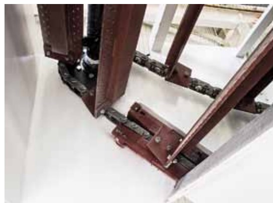
Рис. 2. Разгрузочное жерло сепаратора, расположенное в его передней части
