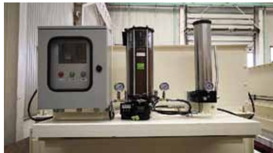
Рис. 5. Система автоматической подачи смазки (опционально)
