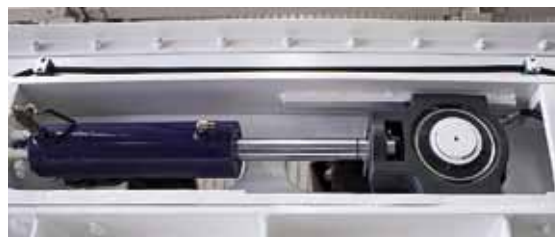
Рис. 6. Натяжной вал, оснащенный регулирующим гидроцилиндром
