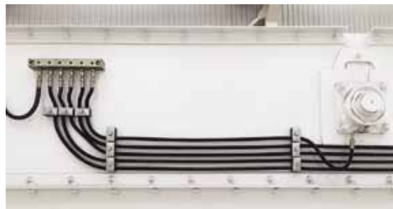
Рис. 4. Система смазки сепаратора – смазка осуществляется из одной точки
