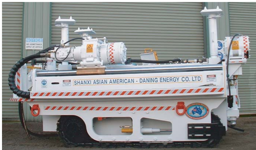
Рис. 2. Буровые станки направленного подземного бурения, выпускаемые Valley Long Wall (Австралия) позволяют бурить скважины глубиной до 1500 м
