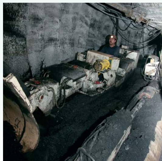
Работа добычного комплекса DBT по выемке маломощных пластов на шахте «Новая-2»
