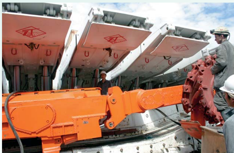
Сборка комплекса для выемки угля производства компании «Joy Mining Machinery», поступившего на шахту «Листвяжная»
