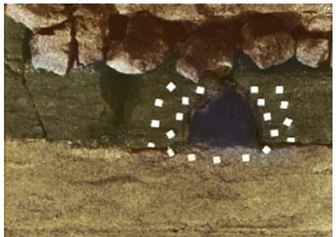
Рис. 1. Физическое моделирование геомеханических процессов при проведении и поддержании выемочных выработок: а — деформационный процесс в пределах выемочного столба; б, в — деформации во вмещающих породах до прохода лавы (общий вид и продольный разрез по бремсбергу); г — при усилении крепления анкерной крепью (после прохода лавы)
