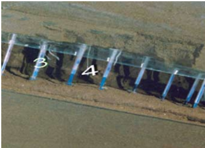
Рис. 1. Физическое моделирование геомеханических процессов при проведении и поддержании выемочных выработок: а — деформационный процесс в пределах выемочного столба; б, в — деформации во вмещающих породах до прохода лавы (общий вид и продольный разрез по бремсбергу); г — при усилении крепления анкерной крепью (после прохода лавы)
