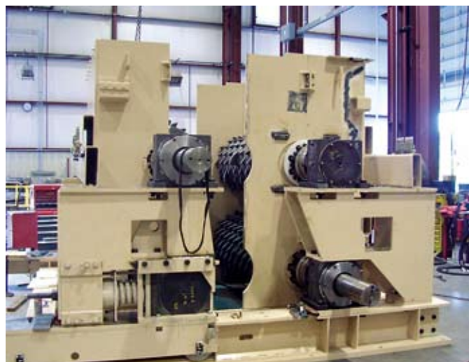
Рис. 1. Двухстадийная четырехвалковая дробилка Roll Crusher на этапе сборки
