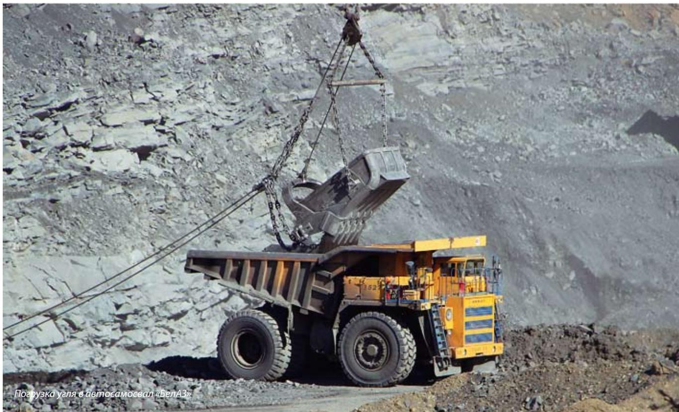
Погрузка угля в автосамосвал «БелАЗ»
