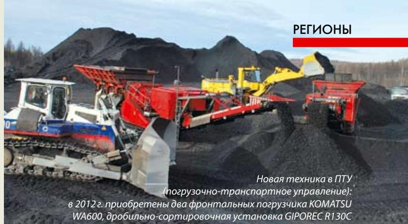
Новая техника в ПТУ (погрузочно-транспортное управление): в 2012 г. приобретены два фронтальных погрузчика KOMATSU WA600, дробильно-сортировочная установка GIPREC R130C
