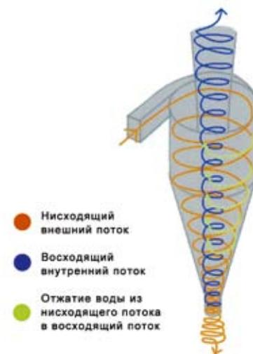
Рис. 5. Распределение потоков в классификационном гидроциклоне
