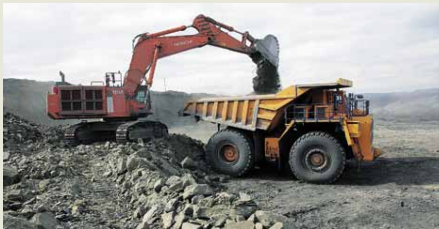
Рис. 15. Разрез «Черногорский». Бригада П.В. Тормозакова на экскаваторе HITACHI EX-1200 дважды в 2017 г. устанавливала мировые рекорды по экскавации горной массы: в июле – 363,8 тыс. куб. м; в августе – 381 тыс. куб. м
