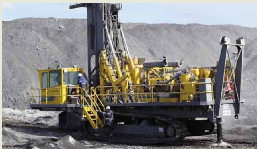
Рис. 10. Июнь 2017 г. Разрез «Тугнуйский». Бригадами буровых станков PitViper-271 № 4603 и № 4823 установлено 4 мировых рекорда по бурению скважин: 52592 м/мес. при однозаходном бурении; 40310 м/мес. при многозаходном бурении; 3612 м/сут. при однозаходном бурении; 1941 м/смену при однозаходном бурении
