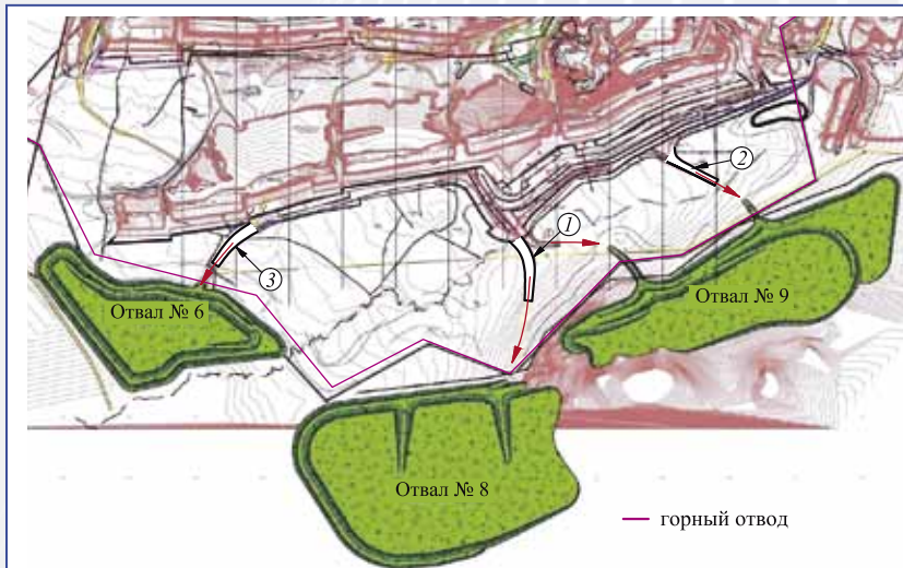
Рис. 2. Размещение прибортовых отвалов №№ 6, 8 и 9 со стороны южного борта разреза «Тугнуйский»: 1, 2, 3 – капитальные траншеи, создаваемые со стороны рабочего борта разреза (реализованное техническое решение)
