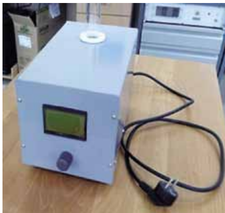
Рис. 2. Прибор для определения содержания диоксида железа в угле Fig. 2. Device for determining iron dioxide content of coal
