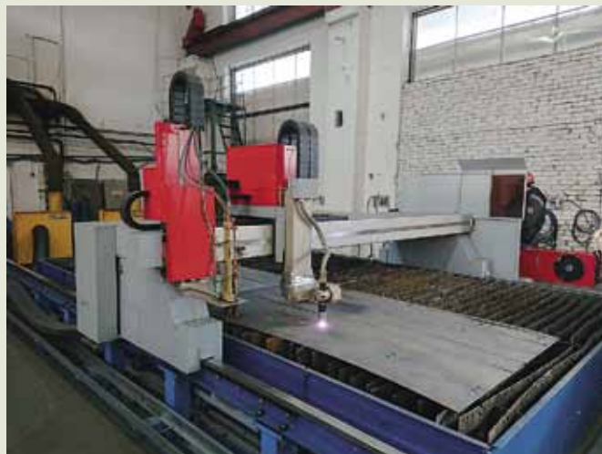
Рис. 5. Установка плазменной резки в Артемовском РМУ
