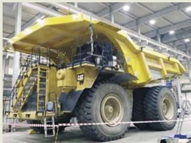
Кузов к самосвалу CAT-789D (грузоподъемностью 180 т)
