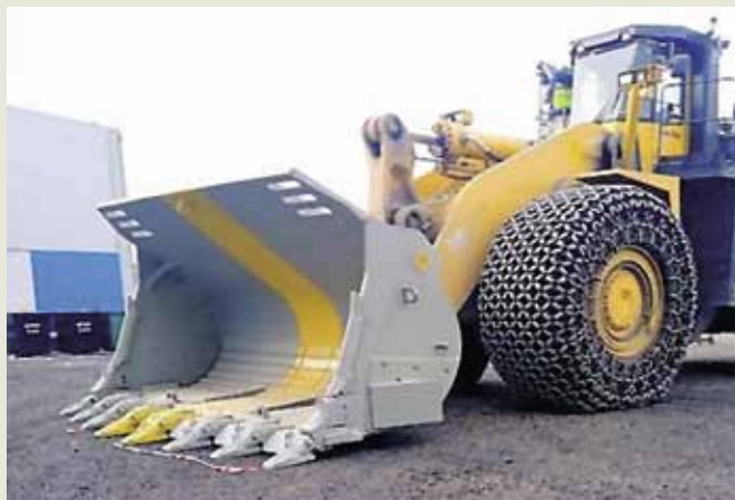
Ковши для погрузчика Komatsu WA900 (емкостью 11,5 м 3 )
