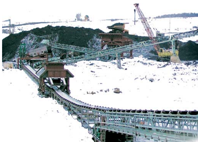
Транспортно-сортировочный комплекс на базе ленточных конвейеров, установленный на шахте «Талдинская-Западная» № 1
