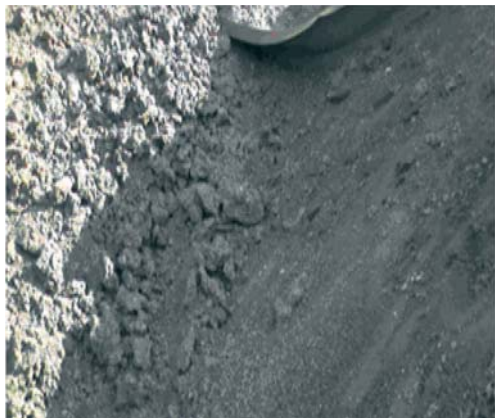
Рис. 2. Хорошо выгоревший шлак от сожженного в топке угля
