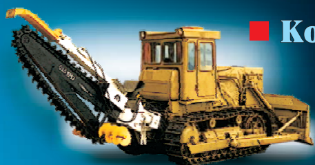
Навесное грунторезное оборудование для трактора Т-170
