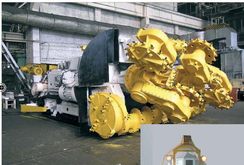
Комбайн проходческо- очистной «Урал-20Р»
