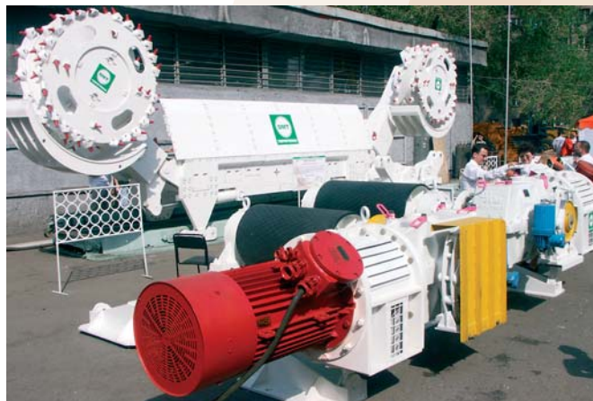
Комбайн К600 и приводная станция ленточного конвейера типа ЛТ ОМТ на выставке «Уголь России и Майнинг-2006»
