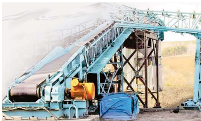
Транспортно-сортировочный комплекс на базе ленточных конвейеров, установленный на шахте «Талдинская-Западная» № 1
