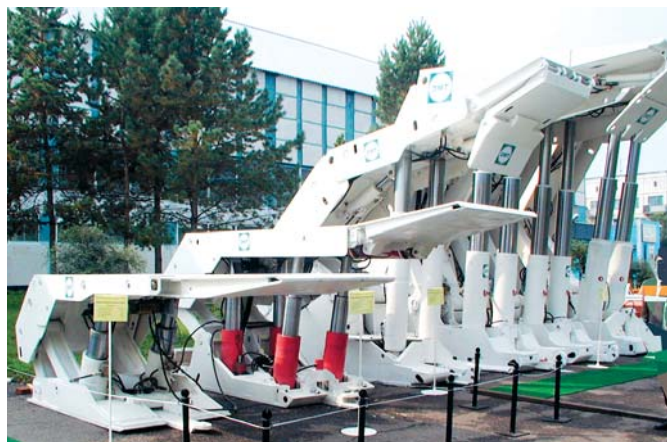
Ряд механизированных крепей ОАО «ОМТ» для пластов мощностью 0,8-6 м
