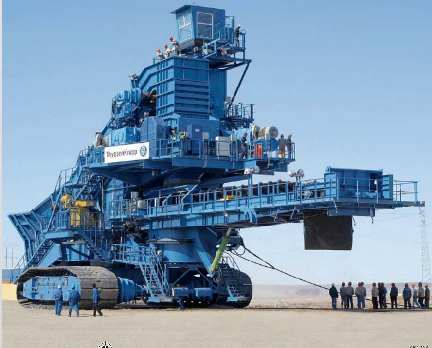
Рис. 1. Полностью мобильный дробильный комплекс для угольного разреза в Китае
