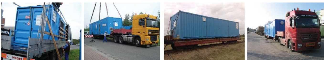
Транспортировка осуществляется одной машиной, без спецразрешения на негабаритный груз.
