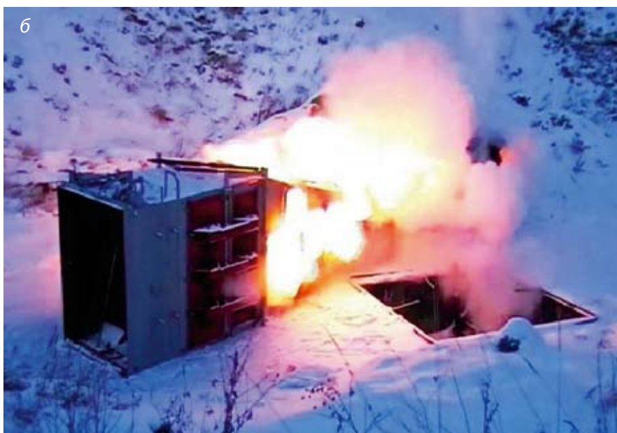
Рис. 5. Подавление взрывного горения пропано-воздушной смеси оптимальной взрывчатой концентрации: а – работа пылеметной mortar; б – работа предохранительных мембран совместно с предохранительным клапаном при отключенной mortar
