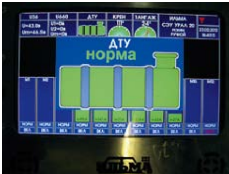
Визуализация данных аппаратуры контроля параметров масла в гидробаке на пульте управления ПУ2
