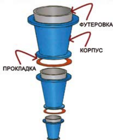
Рис. 3. Конструкция конической части гидроциклона
