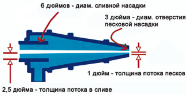
Рис. 1. Разгрузка пульпы через песковую и сливную насадки гидроциклона
