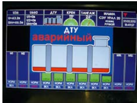
Визуализация данных аппаратуры контроля параметров масла в гидробаке на пульте управления ПУ2
