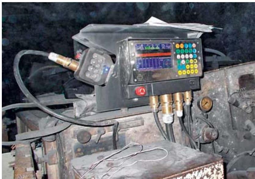
Пульты управления местный ПУ2 и носимый ПУН2 на комбайне КП21, шахта «Алардинская»
