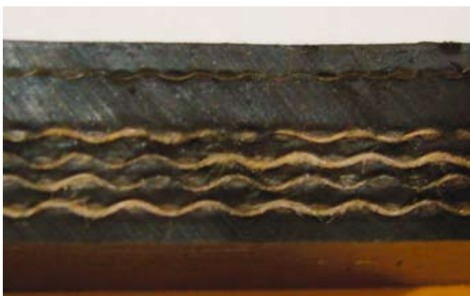
Рис. 5. Теплостойкая лента с базальтовой тканью
