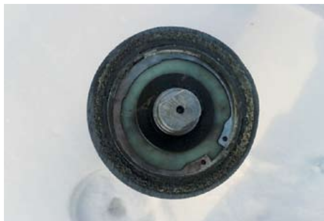
Рис. 10. Ролик из композита
