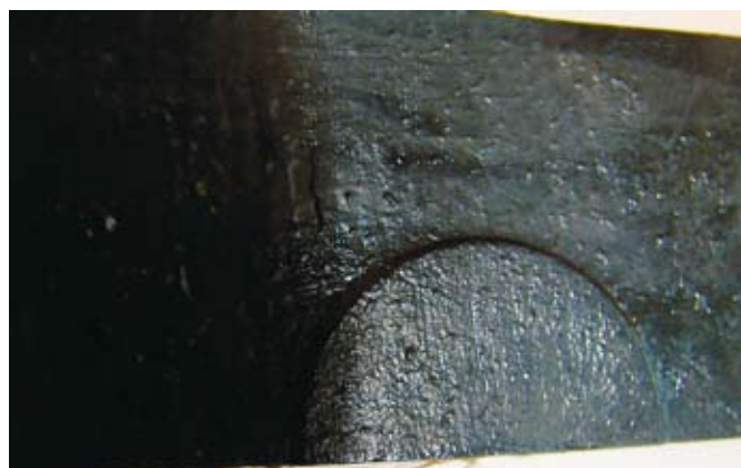
Рис. 6. Испытания на прожиг
