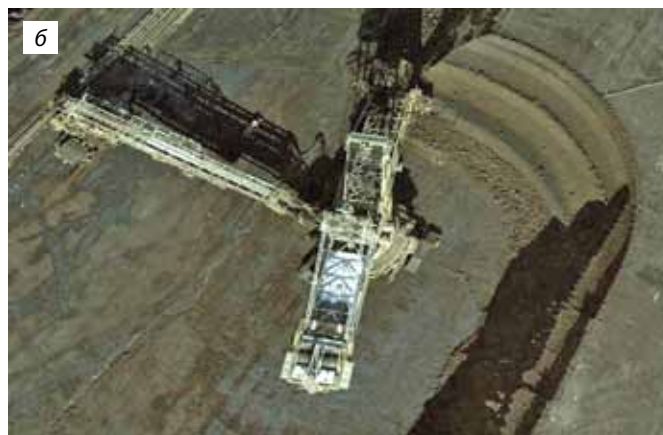
Основная выемочная машина на угольных разрезах Европы – роторный экскаватор: а – на вскрышных работах; б – на добыче угля
