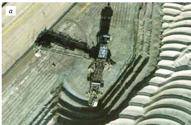
Основная выемочная машина на угольных разрезах Европы – роторный экскаватор: а – на вскрышных работах; б – на добыче угля
