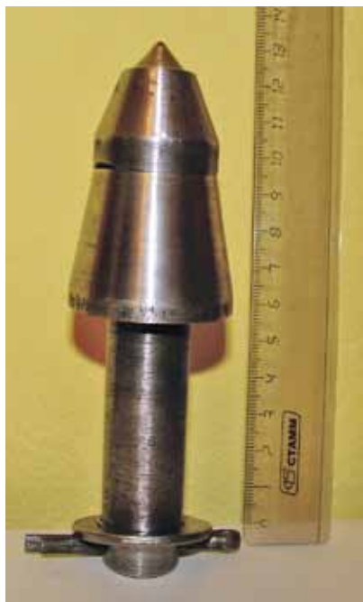
Рис. 2. Резец для комбайна 1ГПКС с поворотной и сменной рабочей частью головки
