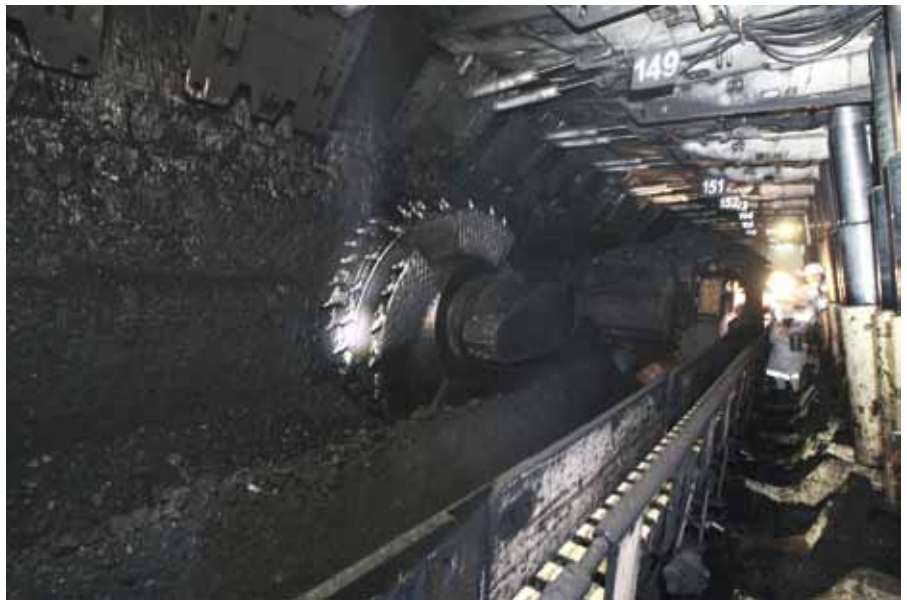
Рис. 7. Нулевая работа СМК с положительным моментом силы, программируемая в монтажной камере
