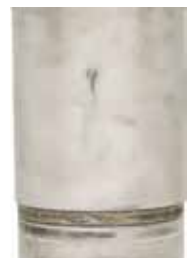
Гильза двигателя, который работал с оригинальной охлаждающей жидкостью, имеющей антикавитационные присадки
