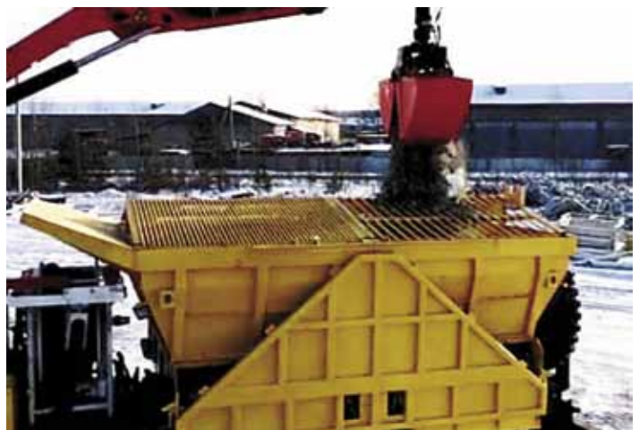
Рис. 5. Загрузка бункеров забоечным материалом Fig. 5. Bunkering with stemming material
