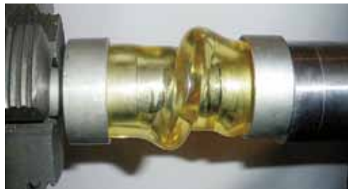
Рис. 3. Мягкий эластомер: а – начало потери устойчивости; б – вид эластомера, приводящий к заклиниванию в скважине
