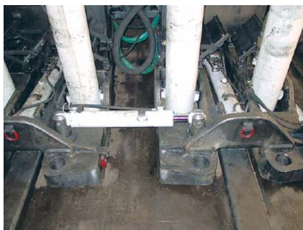
Рис. 7. Домкраты удержания основание — задняя балка на испытательном стенде
