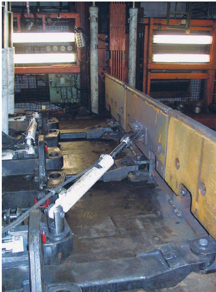
Рис. 6. Диагональные домкраты основание — основание на испытательном стенде
