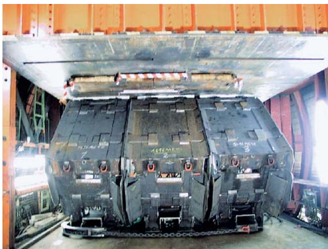
Рис. 1. Секции с концевым натяжением на испытательном стенде
