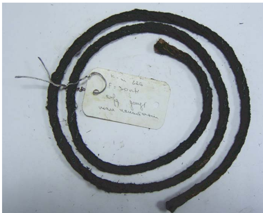
Рис. 6. Джутовый сердечник после испытаний при S=30 кН
