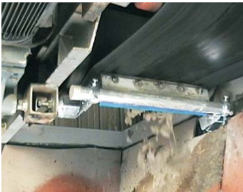
Очистка ленты с использованием скребков Indutechnik
