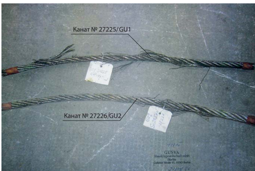
Рис. 4. Стальные канаты после испытаний при S = 20,5 кН
