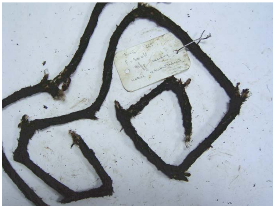
Рис. 5. Пеньковый сердечник после испытаний при S=30 кН
