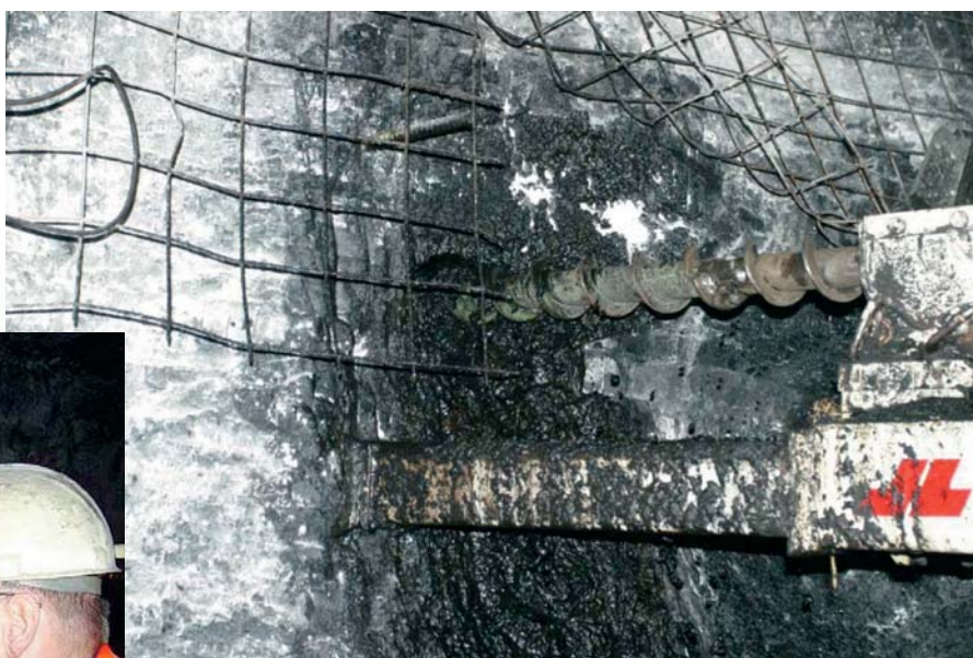
Бурение дегазационных скважин шнековым буровым инструментом
