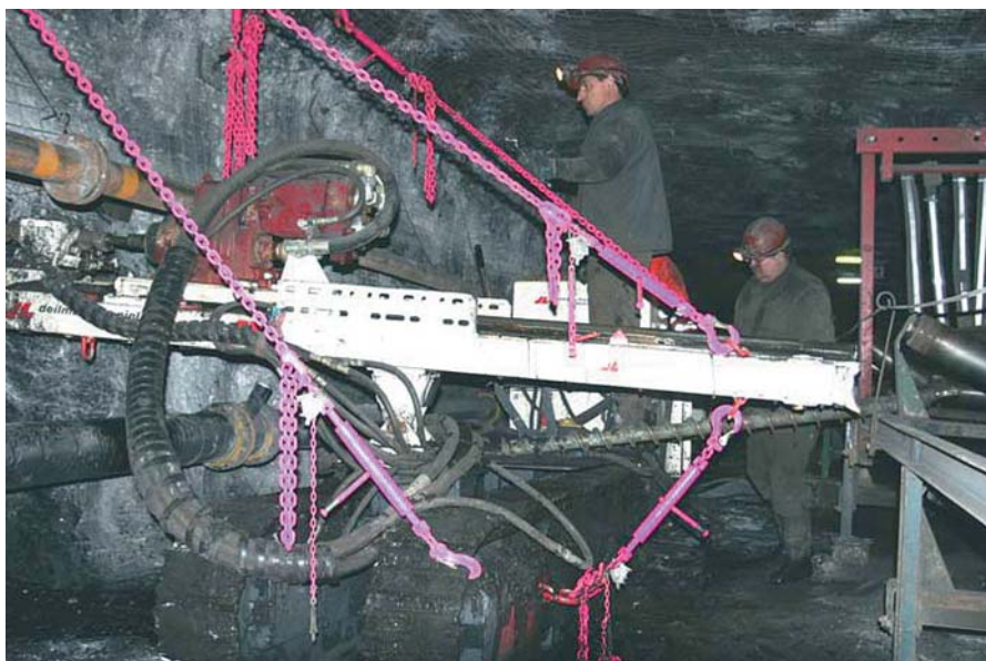
Бурение глубоких дегазационных скважин станком типа PD300
