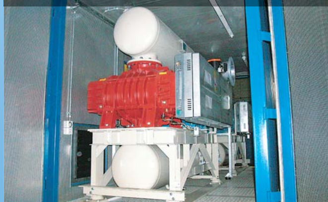
Рис. 2. PGM-Lennetal мобильная дегазационная установка с ротационными насосами. Ротационный насос в насосном модуле
