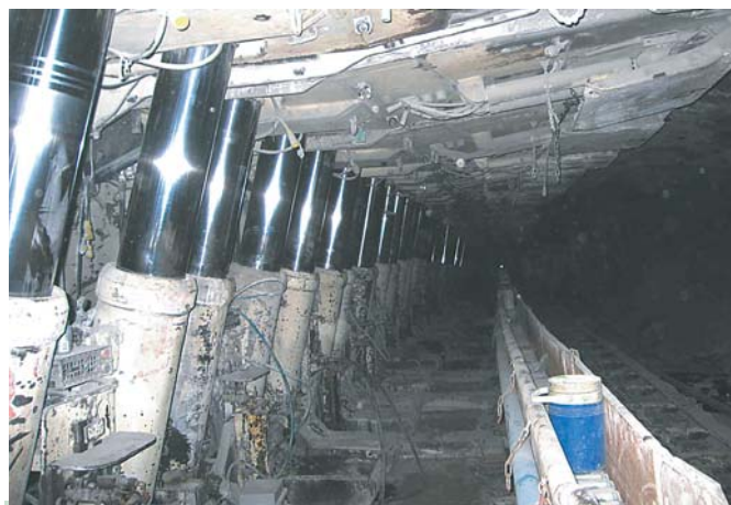
Рис. 1. Крепь Glinik 18/40 POz (2x3500 кН) на шахте, принадлежащей концерну «Сольвей Кемикальс» США (март 2006 г.)
