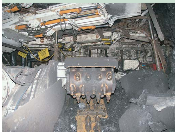
Рис. 16. Дробилка, установленная на забойном конвейере Glinik на шахте «Весела»
