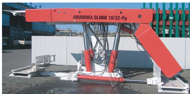
Рис. 8. Крепь Glinik 18/32 Pp для эксплуатации мощных пластов методом с выпуском угля «Sublevel»
