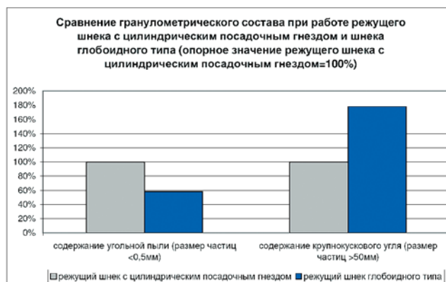
Рис. 2. Сравнение гранулометрического состава при работе традиционного шнека и шнека глобoidного типа (фирма КРУММЕНАУЭР)
