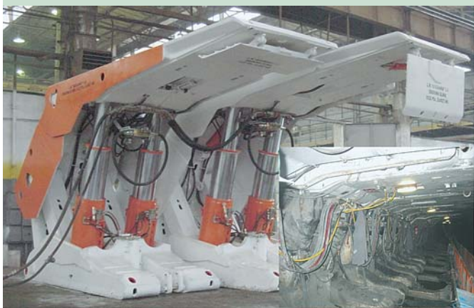
Рис. 2. Крепь Glinik 15/32 POz (2x5027 кН). В нижнем углу — вид лавы на шахте «Богданка».
