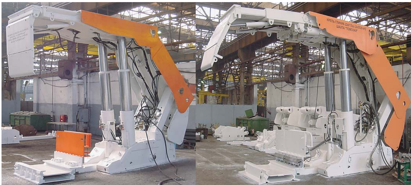
Рис. 4. Крепи Glinik 22/47-POz (2x5529 кН) с выдвигаемым верхняком для шахты «Алардинская» и отклонно-выдвигаемым верхняком для шахты «Томская» (Россия)
