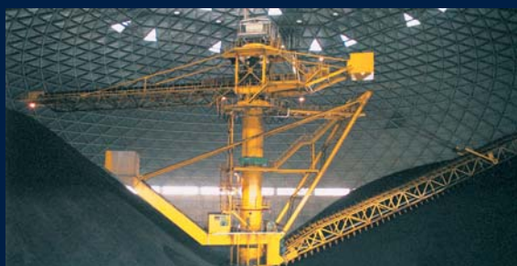
Круглый склад для угля с боковым реclaimerом
