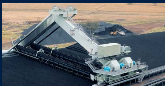
Скребковый реclaimer portalного типа с двойной стрелой для угля
