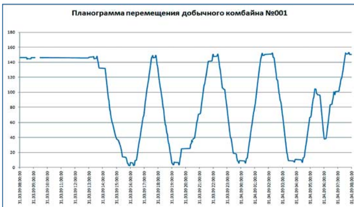
Рис. 6. Планограмма перемещения комбайна
