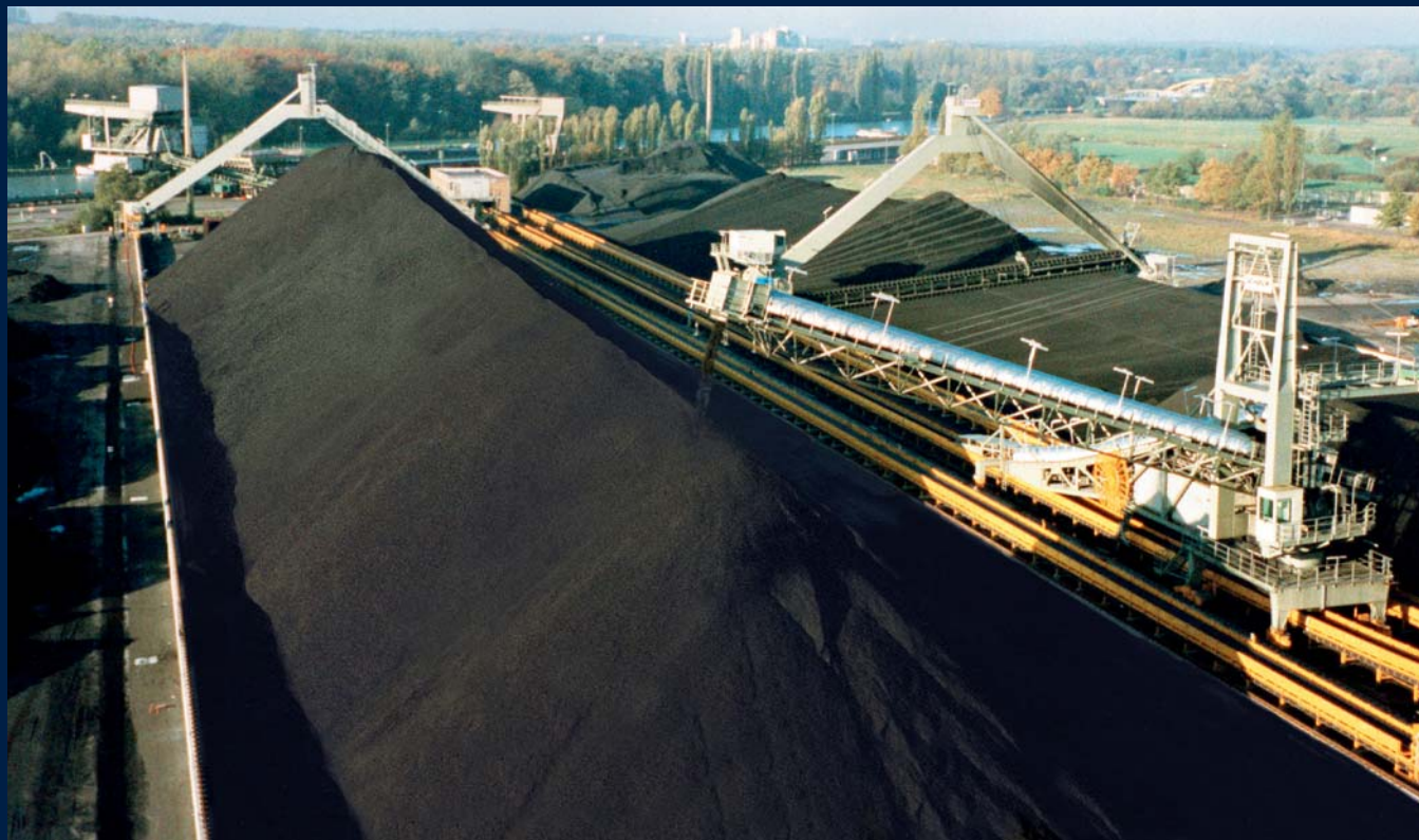
Склад для угля с отвалообразователем и скребковым реclaimerом portalного типа
