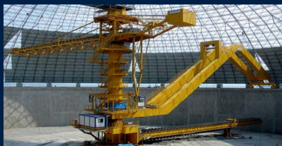
Круглый склад для угля с реclaimerом portalного типа
