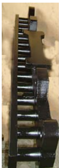
Рейки для бесцепной системы подачи комбайнов разных типов
