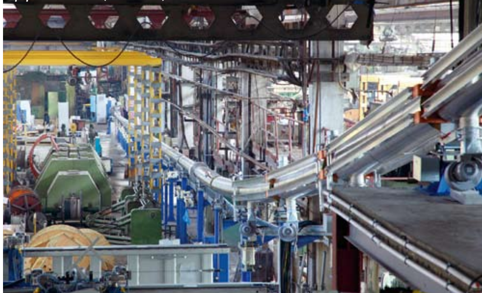
Наклонная линия паровой вулканизации фирмы «Maillefer» (Финляндия)
