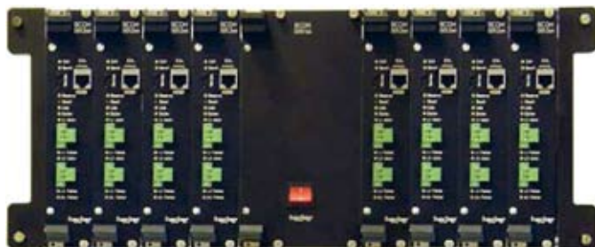
Рис. 4. Соединительный модуль BCOM VoIP для устройства двусторонней речевой связи
