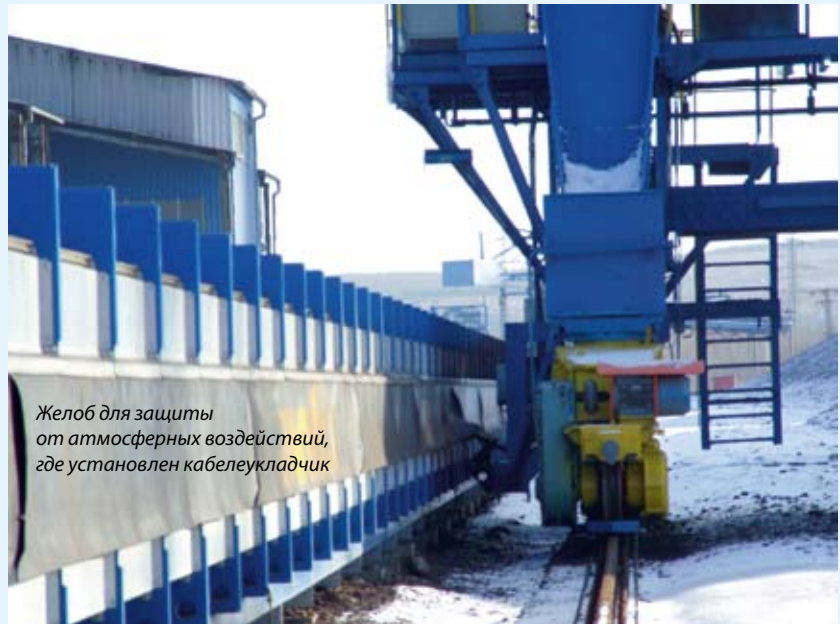
Присоединение кабелеукладчика к передвижному механизму с системой компенсации неровностей трасы
