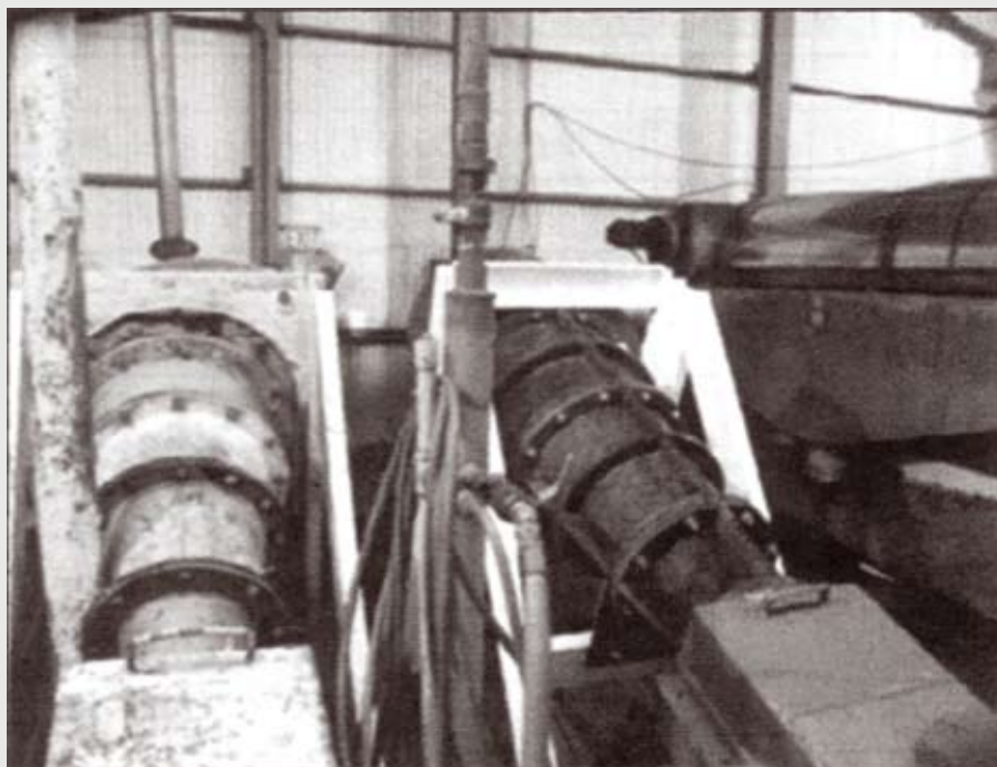
Рис. 8. Циклон CAVEX параллельно с традиционным промышленным циклоном на ОФ, обогащающей уголь крупностью – 12 + 1 мм [13].
