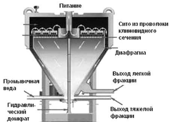
Рис. 7. Схема угольного сепаратора Gekko IPJ [12]
