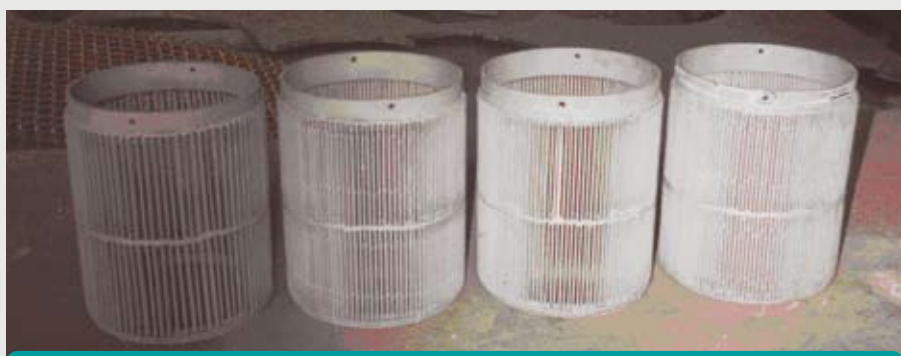
Рис. 5. Шпальтовые цилиндрические сита с щелью размером 4; 2; 1; 0,5 мм
