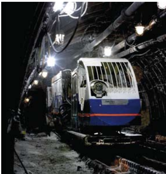
Рис. 5. Напочвенный дизель-гидравлический локомотив с зубчатым приводом на шахте «Зовьюфка»
