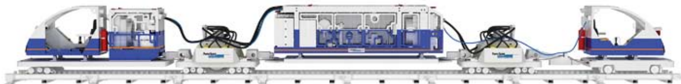
Рис. 3. KSZS — напочвенный дизель-гидравлический локомотив с зубчатым приводом
