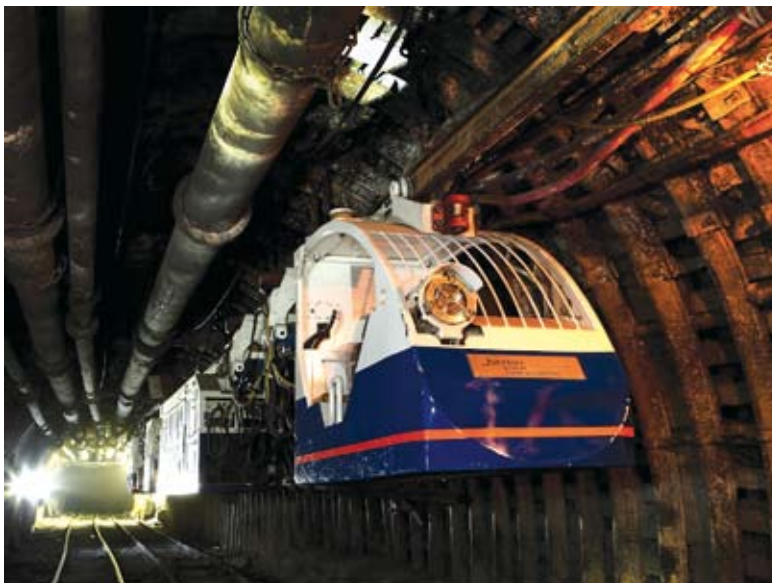
Рис. 6. Подвесной дизель-гидравлический локомотив с зубчатым приводом
