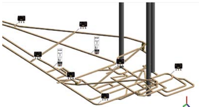
Рис. 9. Модель шахты с транспондерами и точками доступа
