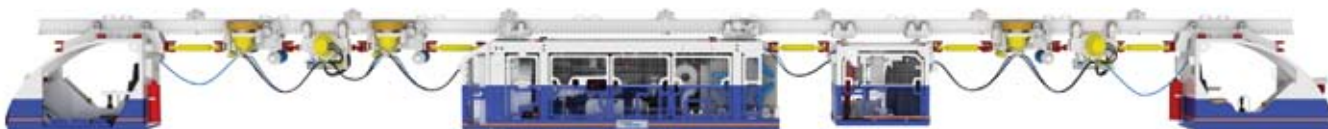
Рис. 4. KPCZ — подвесной дизель-гидравлический локомотив с фрикционно-зубчатым приводом
