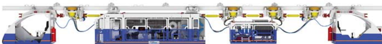
Рис. 1. KPCS — подвесной дизель-гидравлический локомотив с фрикционным приводом
