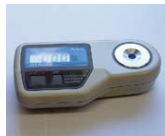
Рис. 2. Цифровая модель ручного рефрактометра на батарейках, не имеющая допуска к применению при работах в подземных шахтах и рудниках
