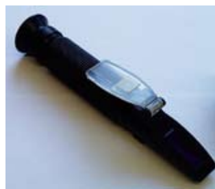
Рис. 1. Ручной рефрактометр, имеющий допуск к применению при работах в подземных шахтах и рудниках
