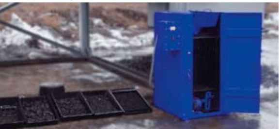
Шкаф виброрассева для определения характеристик дробленого продукта
