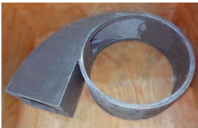
Рис. 1. Входная секция футеровки гидроциклона
