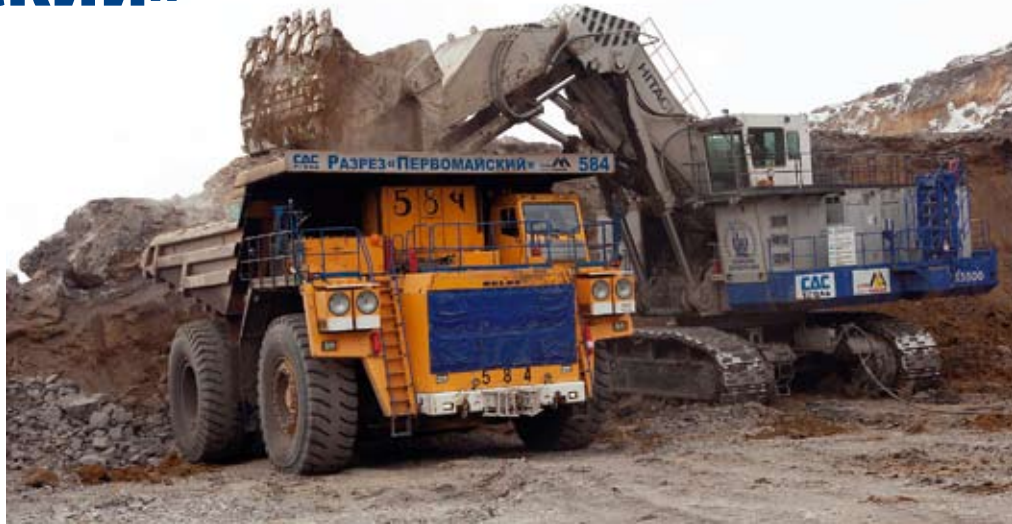
Горные работы на разрезе «Первомайский». Экскаватор Hitachi EX 5500 с вместимостью ковша 27 куб. м с погрузкой вскрыши в автосамосвал БелАЗ-75309 грузоподъемностью 220 т
