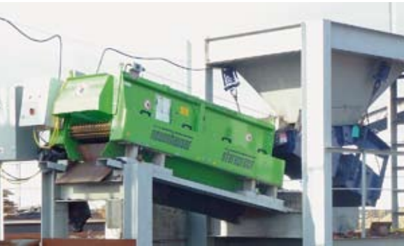
В составе тестовой установки грохочения — вибронитатель Jeffrey Rader и звездочный грохот Starscreen
