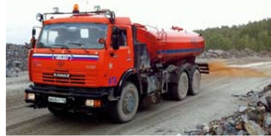
Нанесение пылесвязывающего средства на дороги ОАО «Вишневогорский горно-обогатительный комбинат»
