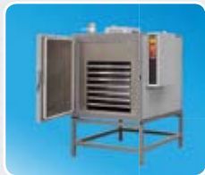
Печь для определения реакционной способности кокса (CRI) и постреакционной прочности кокса (CSR)
