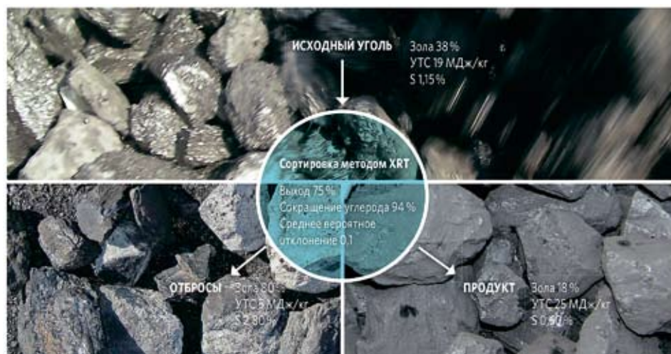
Рис. 4. Схема сепарации угля методом XRT
