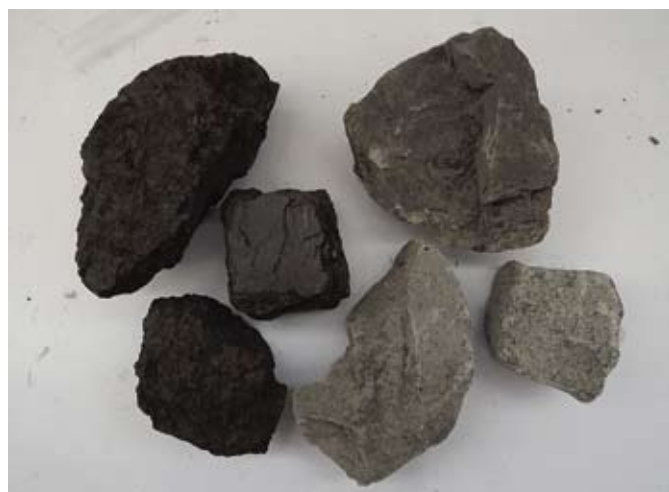
Рис. 5. Продукты сепарации бурого угля: концентрат (слева), отход (справа)
