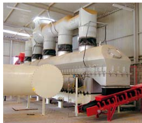
Рис. 8. Установка термической сушилки на основе сушилки с псевдооживленным слоем [5]
