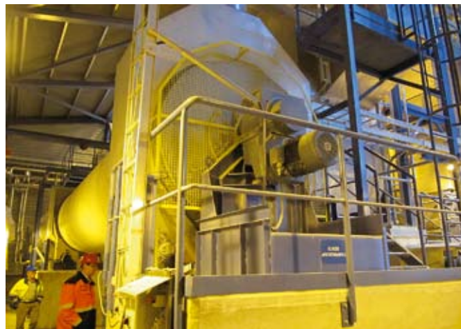
Рис. 1. Торцевая часть сушильного барабана в месте разгрузки материала
