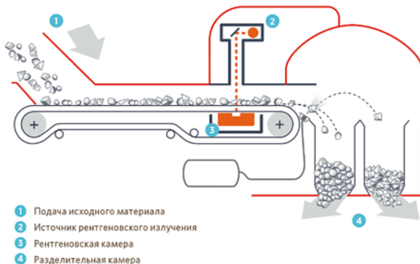
Рис. 2. Схема работы сепаратора TOMRA Sorting GmbH
