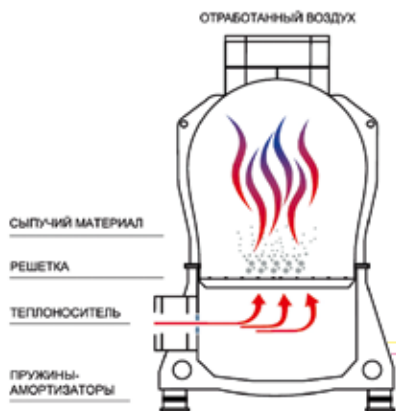
Рис. 6. Схема работы сушилки «виброкипящего» слоя [4]
