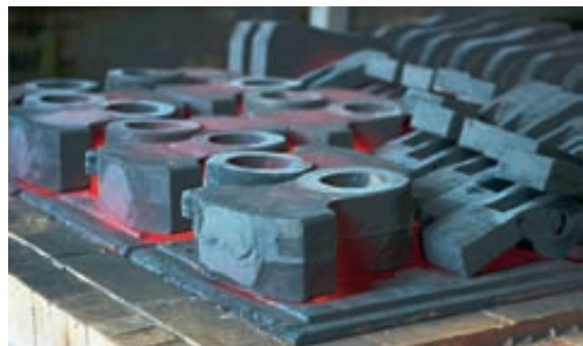
Примеры биметаллических молотков (а) и бил (б). Светлым цветом показаны рабочие части из износостойкого чугуна, а темным — конструкционные части из вязкой удароустойчивой низкоуглеродистой стали
