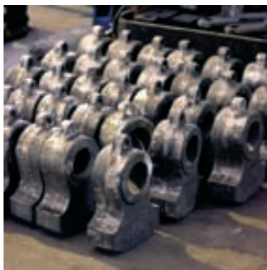
Примеры биметаллических молотков (а) и бил (б). Светлым цветом показаны рабочие части из износостойкого чугуна, а темным — конструкционные части из вязкой удароустойчивой низкоуглеродистой стали
