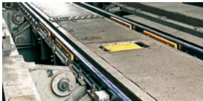
Вагонные весы «РТВ-С», встроенные в вагонопрокидыватель
