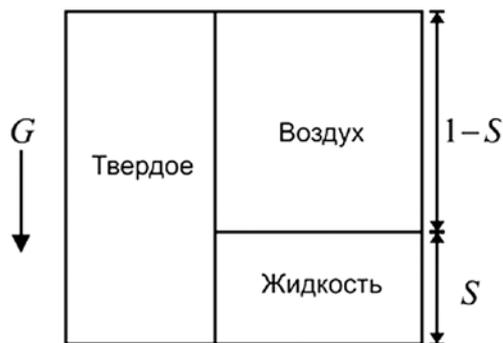
Рис. 1. Схема осадка, условно показывающая соотношение жидкости и воздуха
