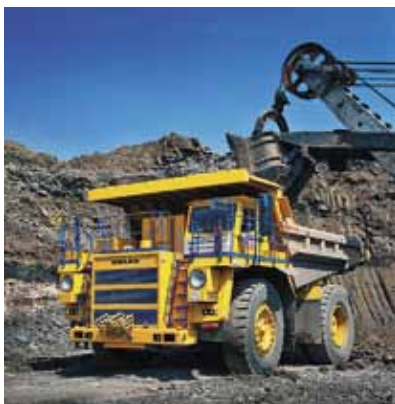
БЕЛАЗ (90 т) с двигателем Cummins QST30
