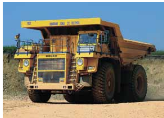
БЕЛАЗ (130 т) с двигателем Cummins KTA50
