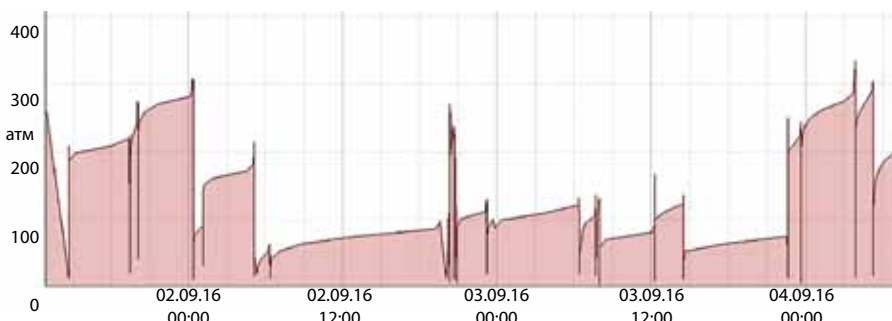
Рис. 2. Фрагмент показаний датчика давления разработанной портативной системы мониторинга нагрузок на секции механизированной крепи очистного забоя
