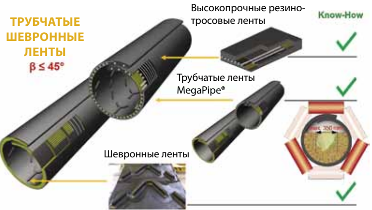
Рис. 2. Крутонаклонный трубчатый конвейер как синтез трех технологий и конструкций конвейерных лент
