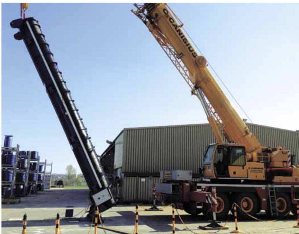
Рис. 5. Эксперименты по определению критического угла наклона конвейера в испытательном центре thyssenkrupp
