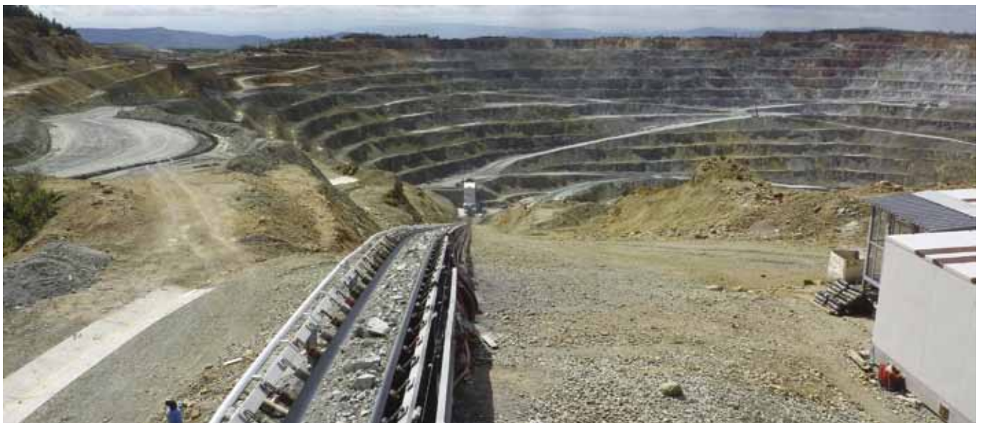
Рис. 4. Дробильная установка и крутонаклонный ленточный конвейер компании thyssenkrupp в меднорудном карьере в Болгарии, оснащенный конвейерной лентой StahlCord Barrier компании ContiTech
