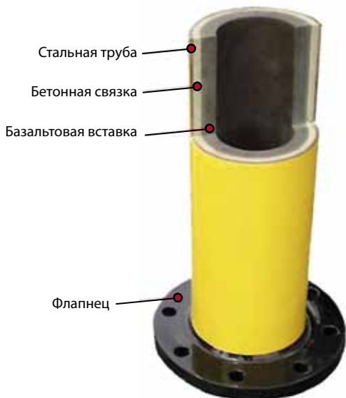
Стальная труба с базальтовой вставкой (EUTIT s.r.o, Чехия)
