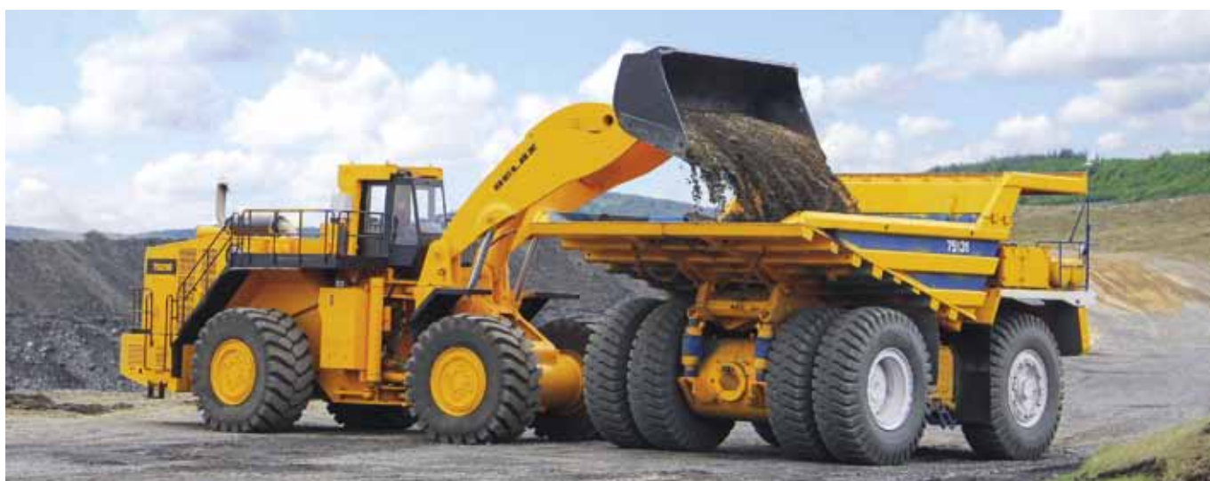
Комплектный электропривод для погрузчика с вместимостью ковша 11,5 куб. м
