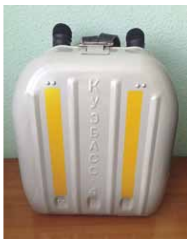
Рис. 3. Изолирующий регенеративный респиратор со сжатым кислородом и сроком защитного действия 4 ч «КУЗБАСС-4»
