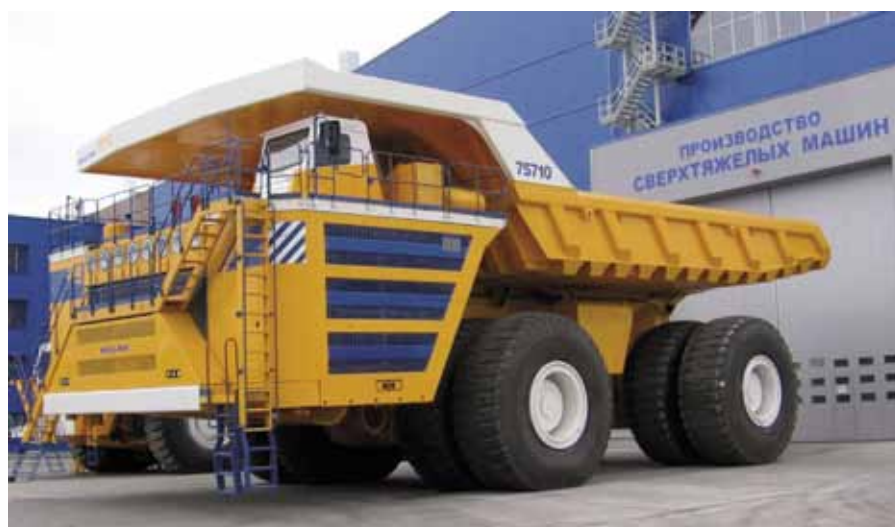
КТЭ-450 Комплектный электропривод для автосамосвала 7571 грузоподъемностью 450 т. Отгружен в январе 2019 г.
