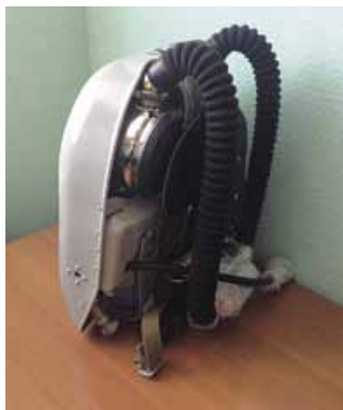
Рис. 2. Изолирующий регенеративный респиратор со сжатым кислородом и сроком защитного действия 6 ч ОВА-6
