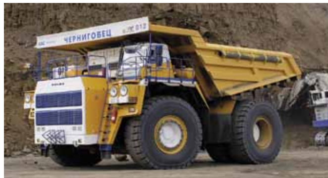
Рис. 2. Карьерный самосвал БЕЛАЗ-75315 грузоподъемностью 240 т с трансмиссией переменного тока
