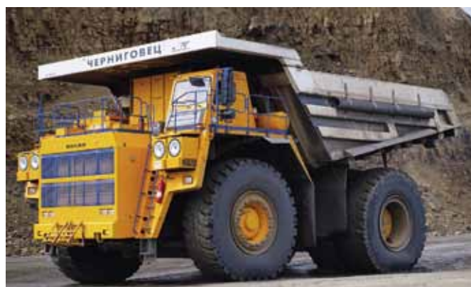
КТЭ-240 Комплектный электропривод для автосамосвала 7530, 7531 грузоподъемностью 220, 240 т
