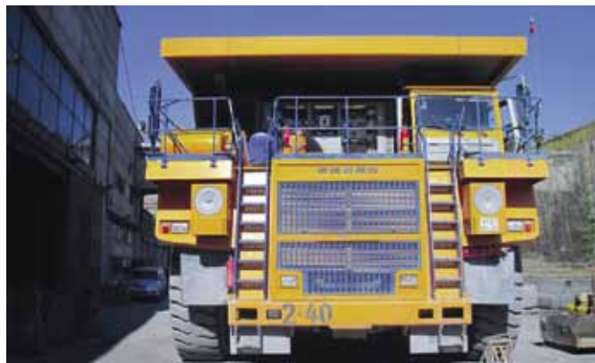
КТЭ-136 Комплектный электропривод для автосамосвалов 7513 грузоподъемностью 130 т
