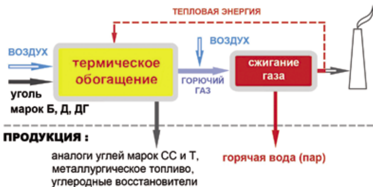
Рис. 2. Принципиальная технологическая схема термического обогащения углей с высоким выходом летучих веществ
