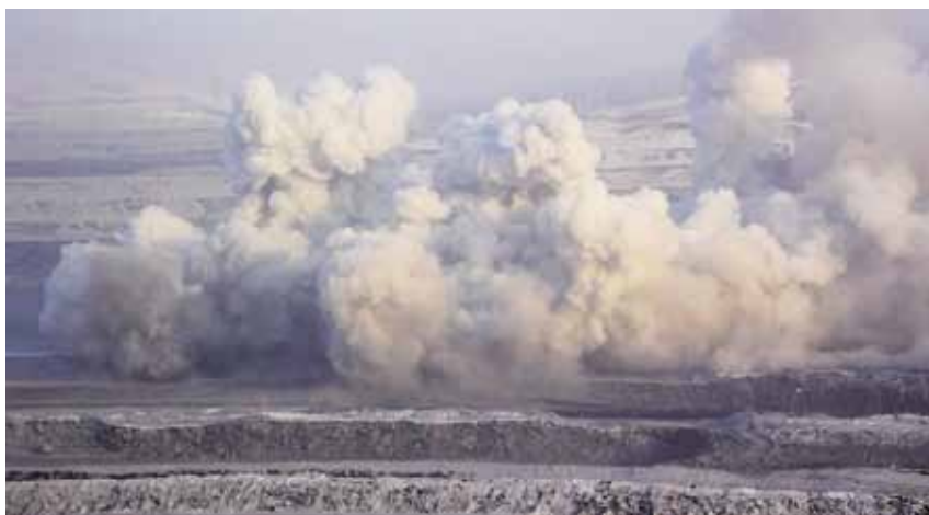
Рис. 5. Результат массового взрыва без использования электронной системы инициирования зарядов
