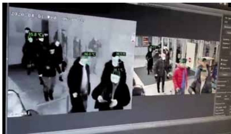
Тепловизор позволяет дистанционно измерять температуру тела
