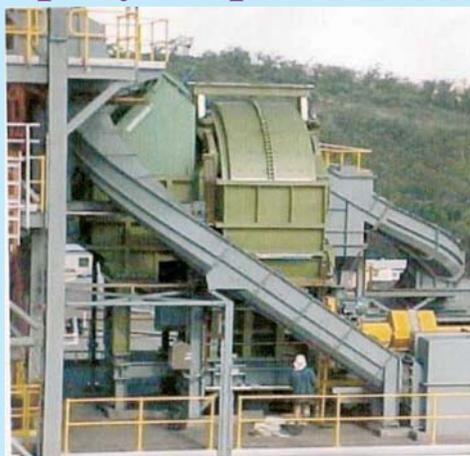
**отсадочная машина ROMJIG, Тип 20.50.808-3 L,
