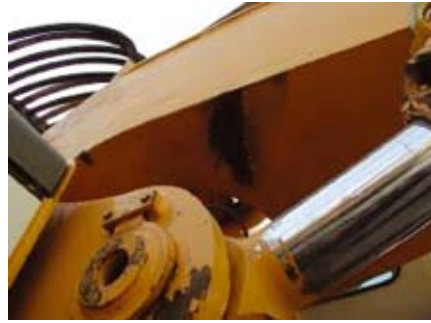
Фото 1, 2, 3. Разрушение металлоконструкций рамы и рабочего оборудования гидравлических экскаваторов
