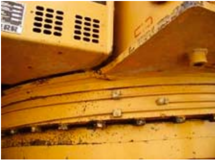
Фото 1, 2, 3. Разрушение металлоконструкций рамы и рабочего оборудования гидравлических экскаваторов
