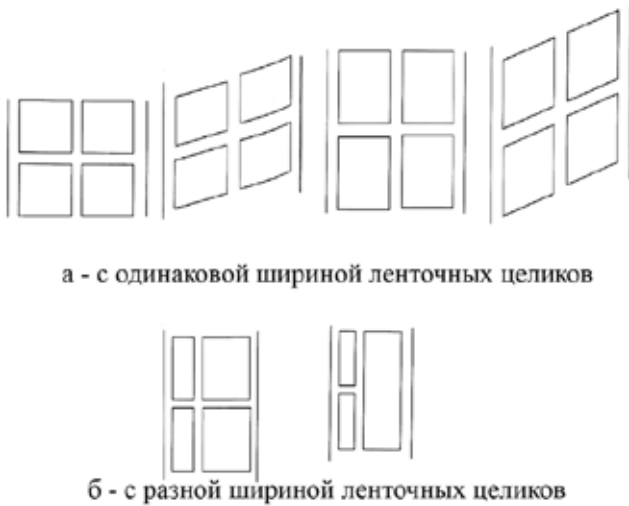
Рис. 4. Варианты расположения выработок и целиков при трехштрековой подготовке выемочных участков: а – с одинаковой шириной ленточных целиков; б – с разной шириной ленточных целиков
