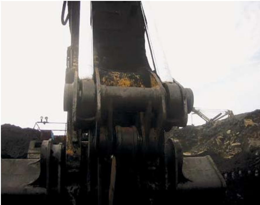
Фото 4. Износ сочленений гидравлических экскаваторов
