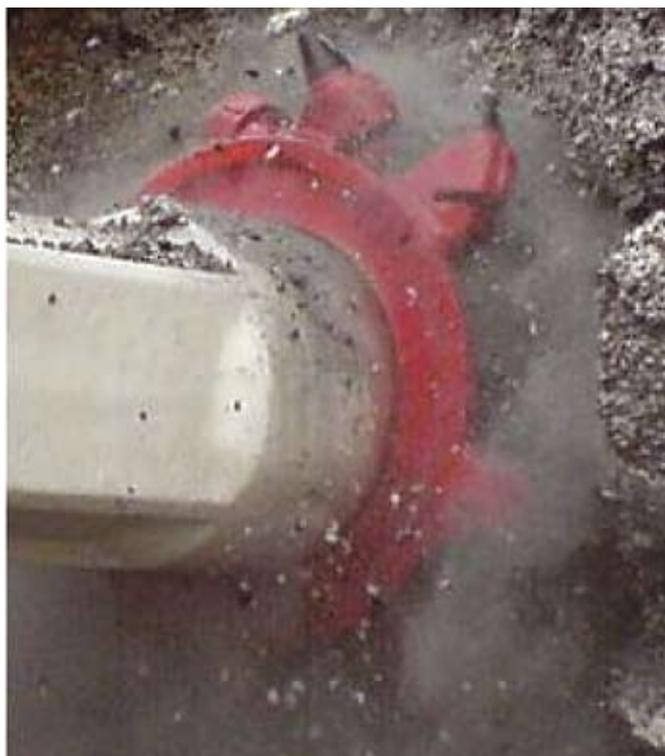
Рис. 4. Разрушение массива продольно-осевой коронкой
