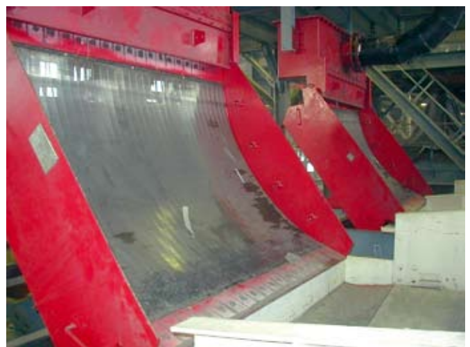
Рис. 2. Дуговые сита, установленные перед грохотом на обогатительной фабрике
