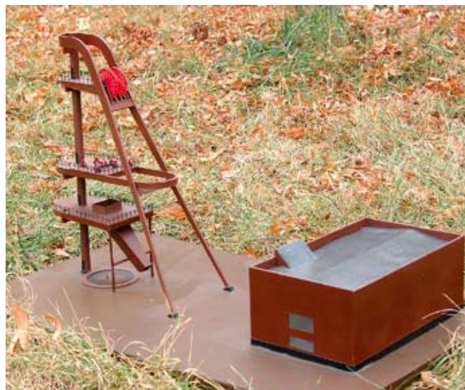
Рис. 3. Макет стального копра многофункционального назначения на период проходки
