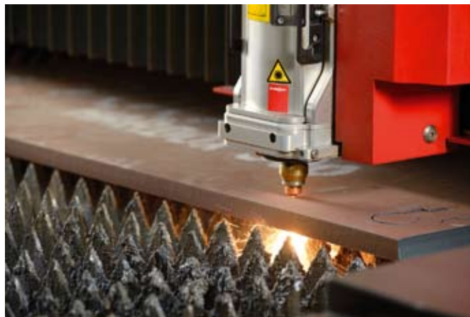
Исключительные свойства листовой стали Hardox 500 обеспечивают легкость лазерной резки листов толщиной до 25 мм. Фото © Bystronic
