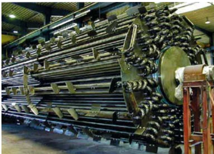
Рис. 4. Внутреннее устройство барабанной паровой сушилки [2]
