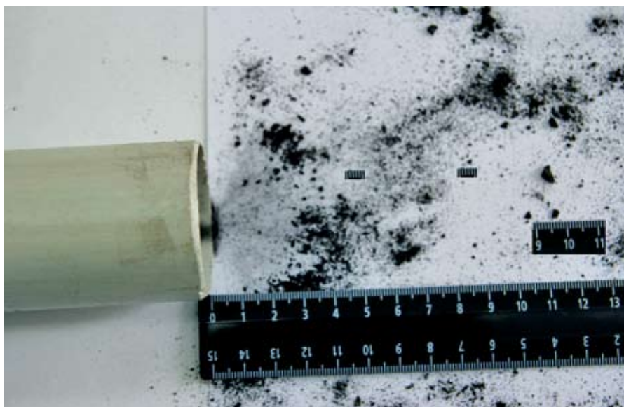
Рис. 4. Фрагмент исследования эффективности всоса угольной пыли при расположении вентиляционной трубы вне выработки
