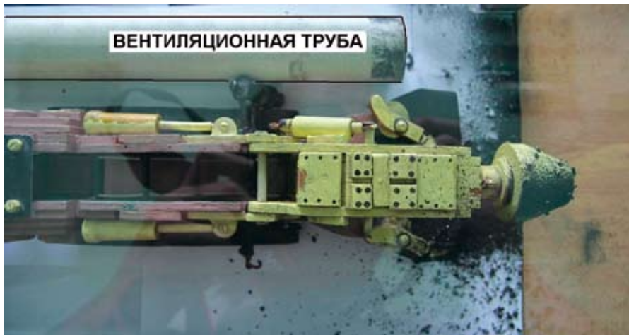
Рис. 3. Схема расположения комбайна избирательного действия и вентиляционной трубы при всасывающем способе вентиляции забоя выработки при моделировании (вид сверху)
