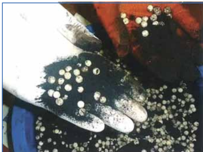
Рис. 4. Молекулярные сита (шарики, гранулы) представляют собой наноэлементы, которые обычно используются для удаления примесей из воздушной, аэрозольной или жидкой среды
