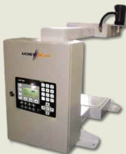
Рис. 11. Анализатор уровня влажности, работающий на микроволнах, используется для проактивного применения мер по поддержанию необходимого уровня влаги в угольной массе*
