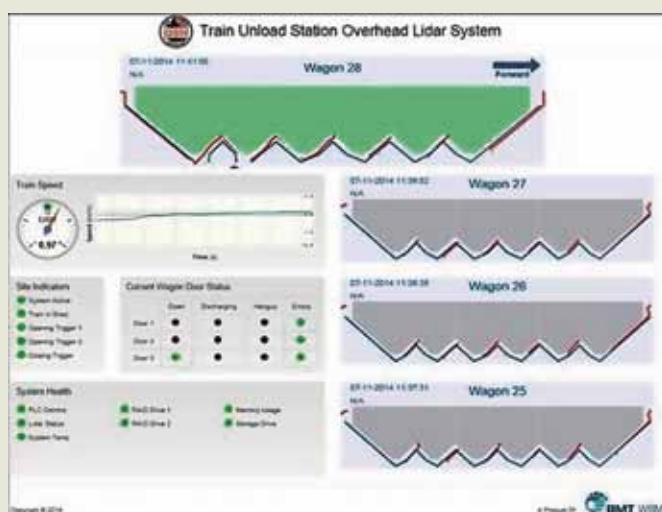
Рис. 10. Система 3D LIDAR используется для мониторинга состояния вагонов для их полной очистки после разгрузки*
